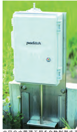
水田の水管理工程を自動制御する「paditch gate (パディッチゲート)」
